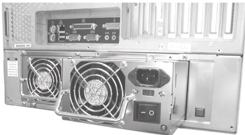
図9-15 電源装置の取り外しと取り付け
