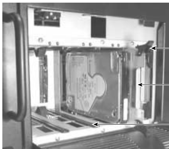
Figure 1-14 Intérieur du logement des unités de lecture
