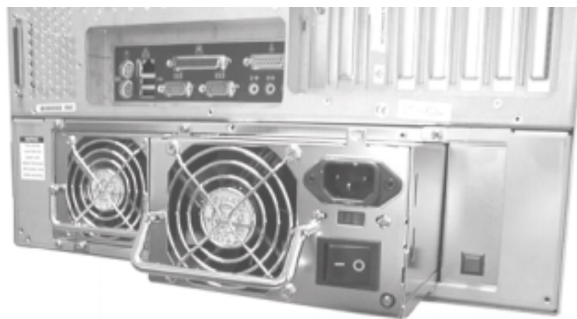
Figura 9-15 Extracción e instalación de la fuente de alimentación
