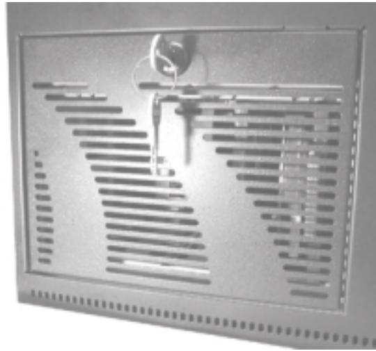
Figura 1-13 Compartimento para unidades de disco RAID extraíbles, con la puerta cerrada
