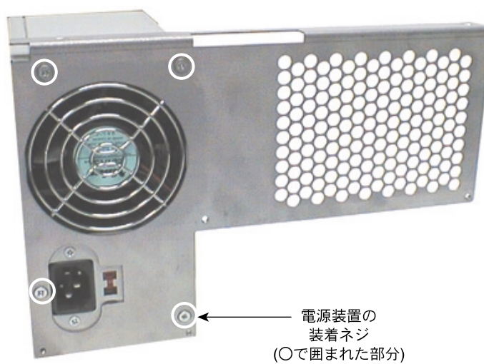
図9-12 電源装置の装着プレート
