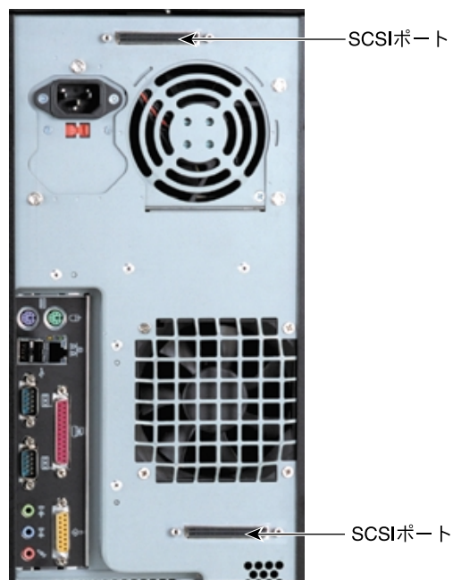
図 1-5 ベースユニット背面の SCSI ポート
