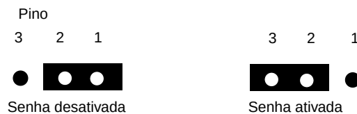
Figura 8-3 Determinando a posição dos jumpers de senha
